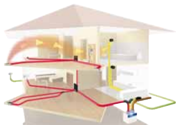
Kontrollierte Be- und Entlüftungsanlage
