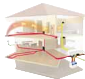
Kontrollierte Be- und Entlüftungsanlage
