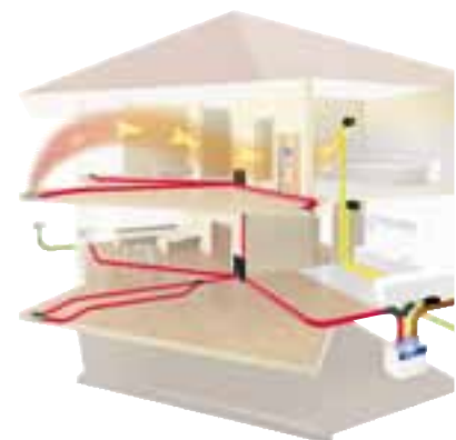
Kontrollierte Be- und Entlüftungsanlage
